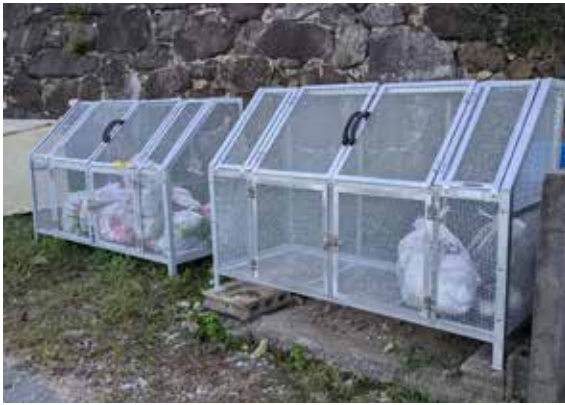
骨組み以外は網目になって、雨も溜まらない
