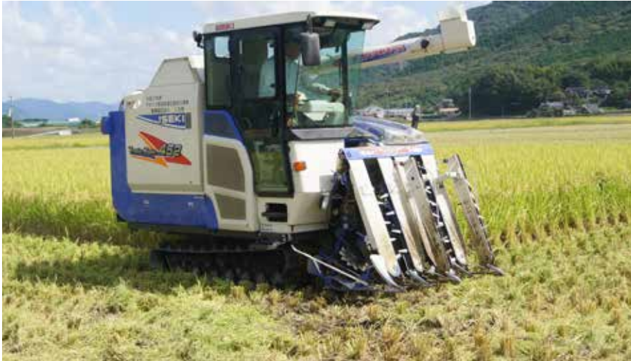
稲と雑草の状況を見て速度調整。脱穀ドラムに送りすぎると停止してしまう
