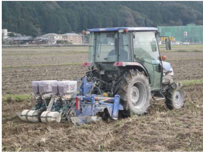
トラクターに取り付けられた麦植え用のアタッチメント
