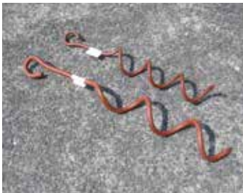
鉄製の螺旋杭、大小の二種類
