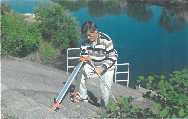
検尺とオートレベルを使い、構造物を中心に測定
