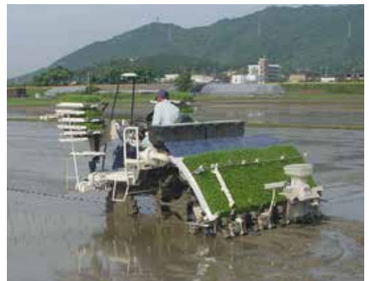
田植え機の前方にある高く上がった部分がGPSアンテナ、直進やターンの細かい設定も必要
