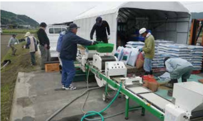
培養土、籾、肥料などが手際よくセットされ、水分補給で完了
